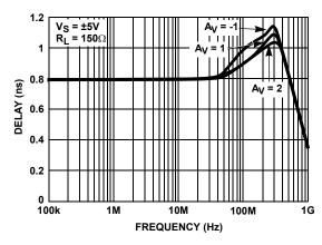
FIGURE 6. GROUP DELAY vs FREQUENCY
